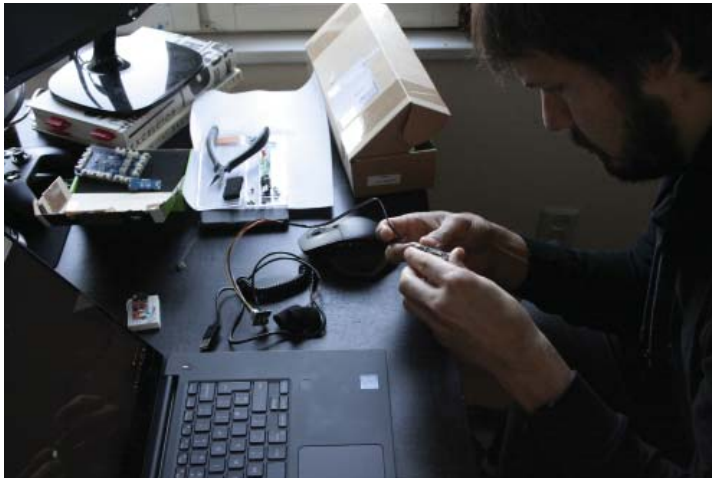
Arduino baasil toimiva naha galvaanilise reaktsiooni sensori komplekteerimine. Sõrmede külge kinnitatav sensor mõõdab katseisiku mikrohigi taset. Naha elektrijuhtivuse ja -takistuse pinnalt arvutatakse välja ka inimese aktiivsustase.
