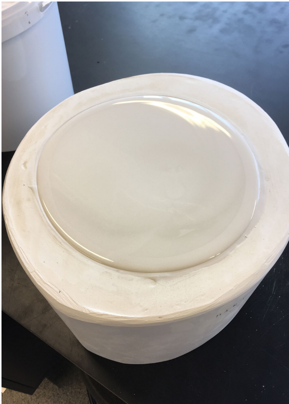
Vedelat portselani täis kipsvorm
