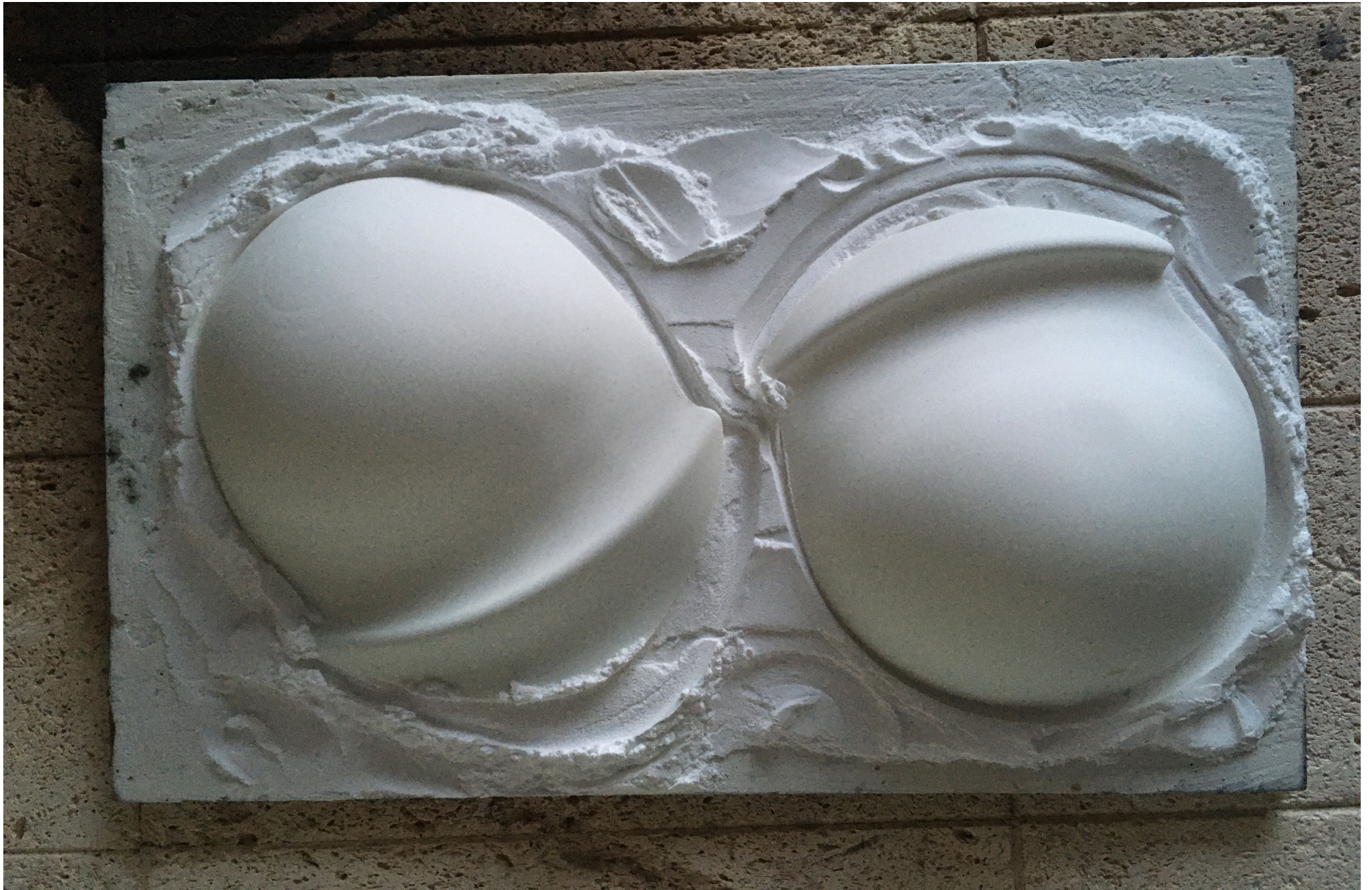
Peale põletust alumiiniumoksiidi kihil
