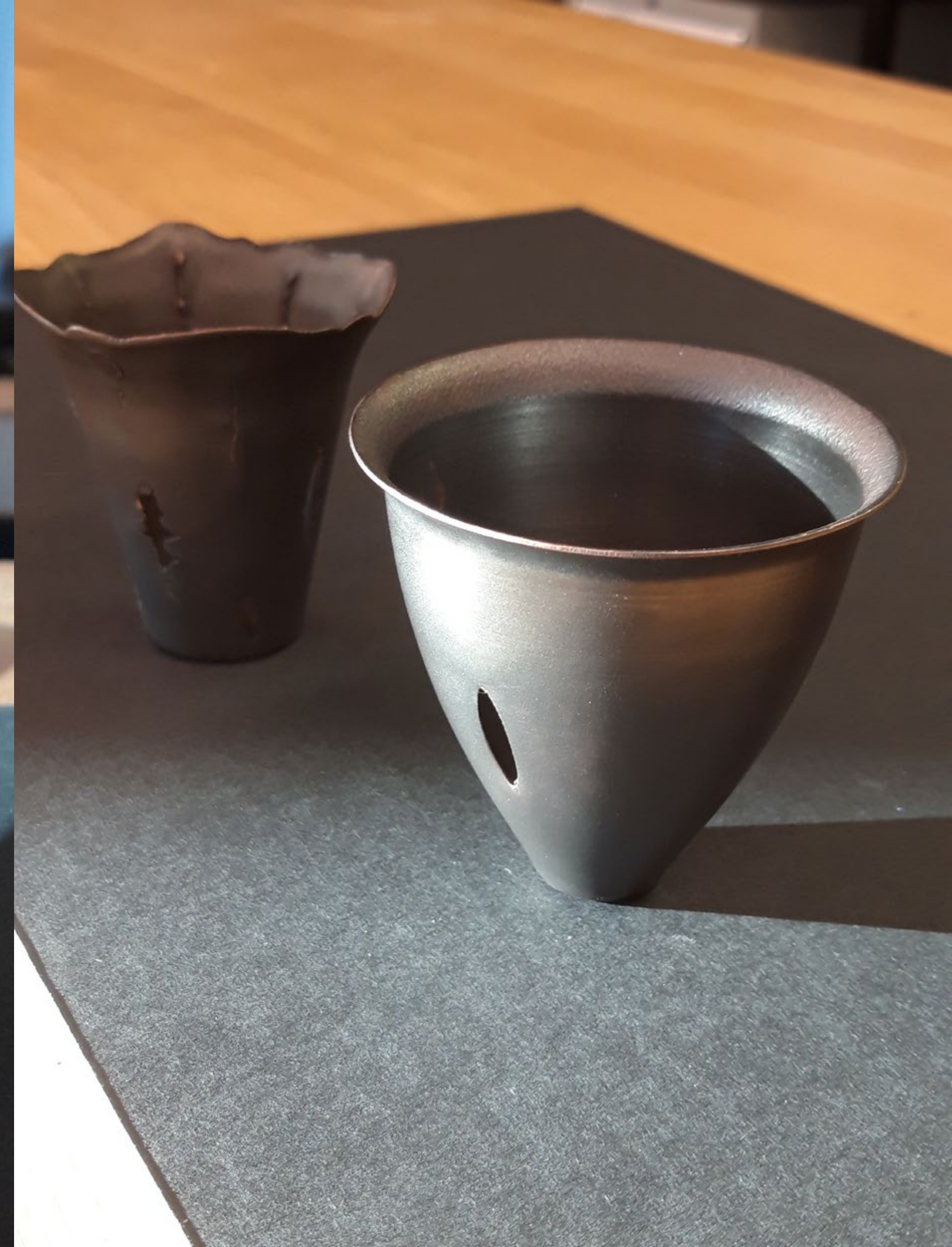
Trugimis kursusel valminud vormid, liivapritsi ja ebonoliga töödeldud
