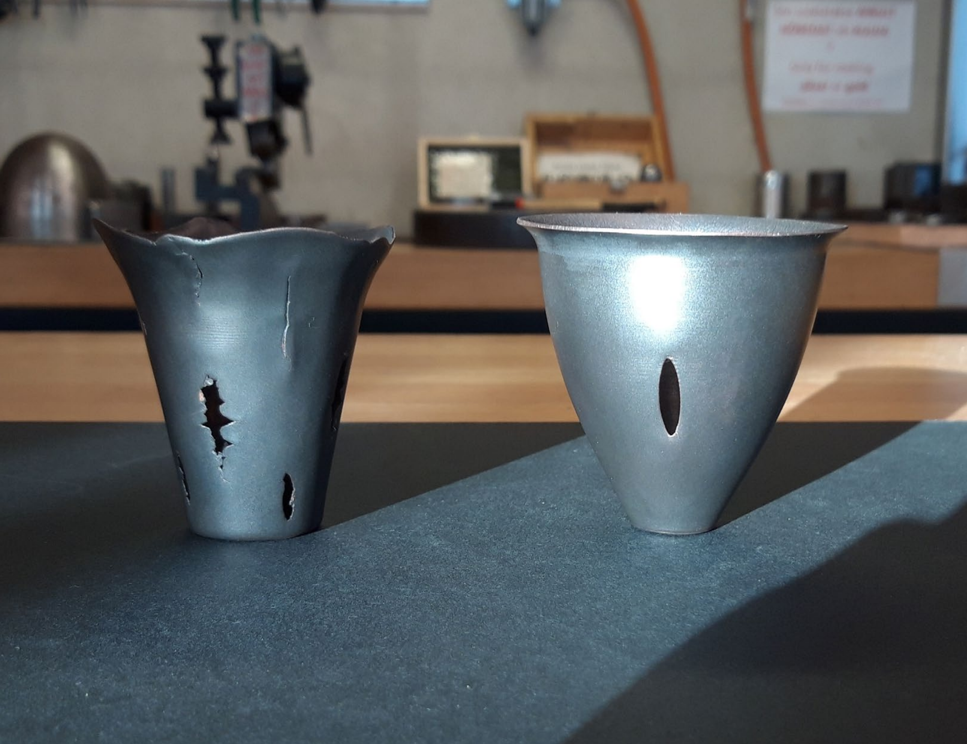
Trugimis kursusel valminud vormid, liivapritsi ja ebonoliga töödeldud
